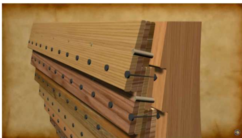
三枚一組の板張り板の ブラッシング 木釘による肋骨への取付け
