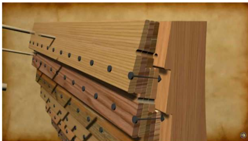
三枚一組の板張り板の ブラッシング 木釘による肋骨への取付け
